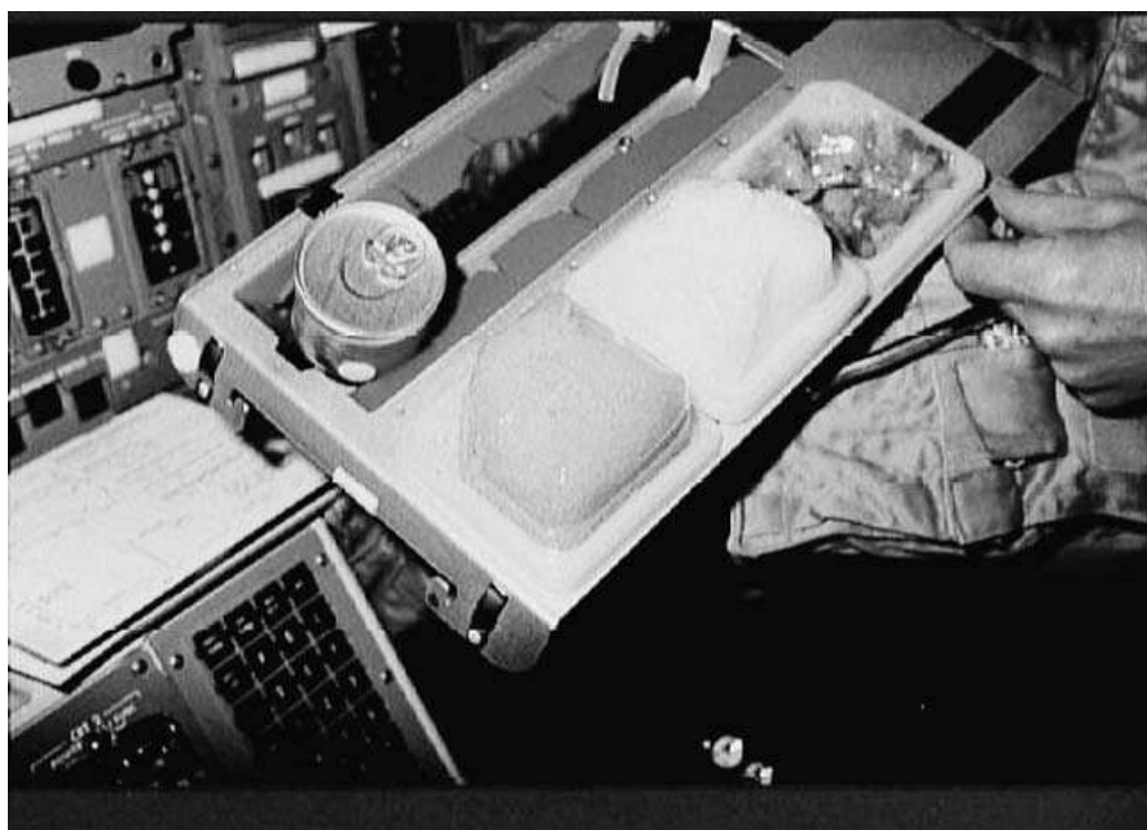
Het dienblad dat wordt gebruikt in de spaceshuttle en het ISS bestaat uit vakjes waarin standaardformaat bakjes met eten en blikjes vastgezet kunnen worden. Het blad zelf kan aan het been van een astronaut of aan een vast oppervlak worden bevestigd. [NASA]
