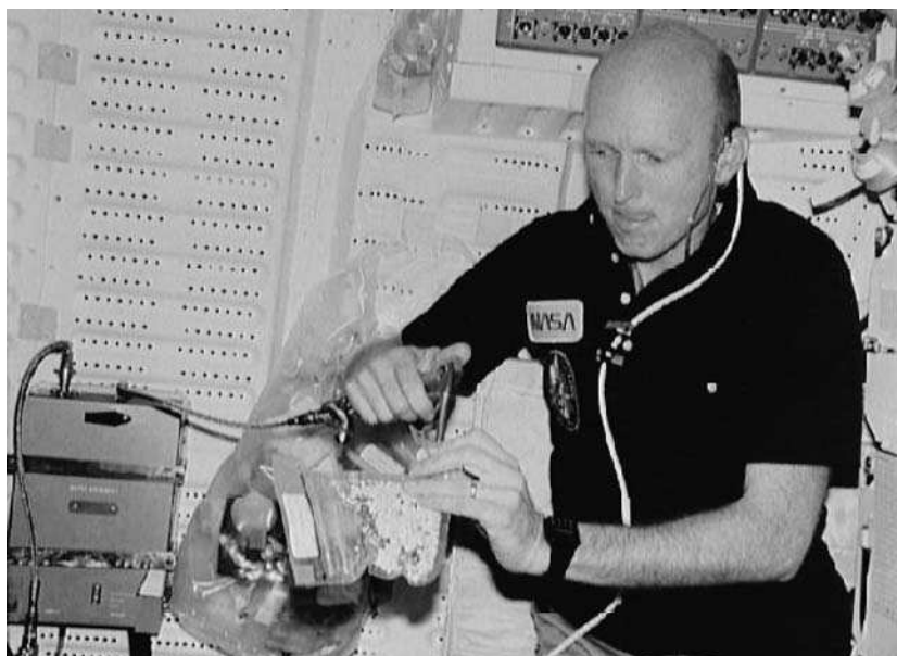
Zakjes gedroogd voedsel worden aan boord van de spaceshuttle en het ISS met warm water ingespoten om warme maaltijden te verkrijgen. [NASA]
