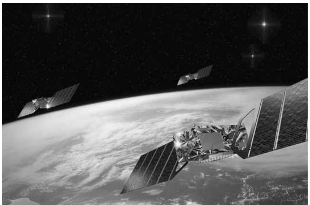
Galileo. Zo dicht bij elkaar als op deze afbeelding komen de Galileo satellieten niet, maar voor elke locatie op aarde zullen er zich altijd tenminste vier boven de horizon bevinden. [ESA]
