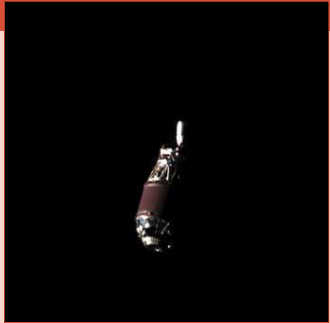
Deze tweede trap van een H-2A raket draait al sinds 2009 rond de Aarde, als zij gefotografeerd wordt door de ADRAS-J satelliet. [Astroscale]
