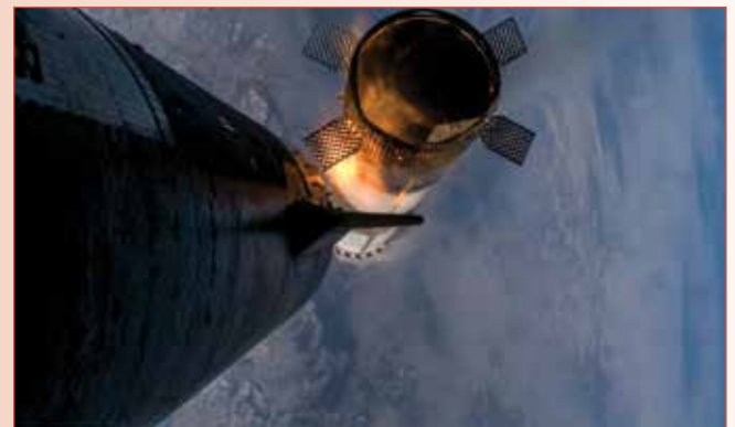
Bijna drie minuten na de lancering, wordt de 70 meter lange Super Heavy booster van het Starship gescheiden. [SpaceX Webcast]
