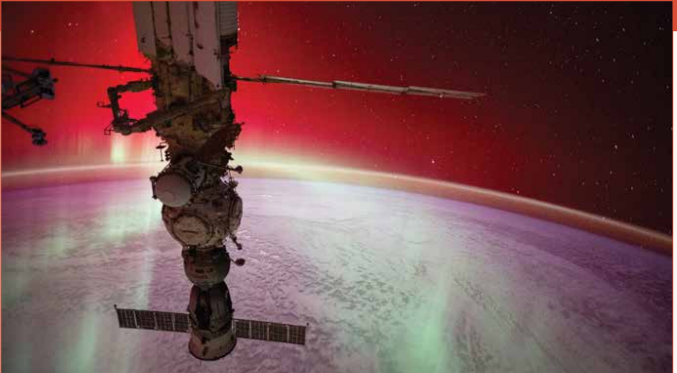
Aurora boven de zuidelijke Indische Oceaan. Van onder naar boven zijn de Soyuz MS-25, de koppelmodule Prichal, het laboratorium Nauka en een deel van de in Nederland gebouwde robotarm ERA zichtbaar. [NASA]
