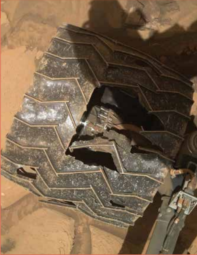
Links: meer dan twaalf jaar op Mars heeft zijn tol geëist van de wielen van de Mars Curiosity rover. Desondanks blijft de rover mobiel. [NASA/JPL] Rechts: De in 2021 gelande Perseverance rover nadert nu de kraterrand van Jezero Crater met een spectaculair uitzicht tot gevolg. [NASA/JPL]
