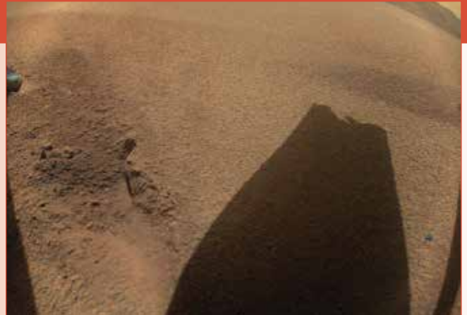
Op deze door Ingenuity gemaakte opname is aan de schaduw te zien dat de tip van het rotorblad is afgebroken. [NASA_JPL]
