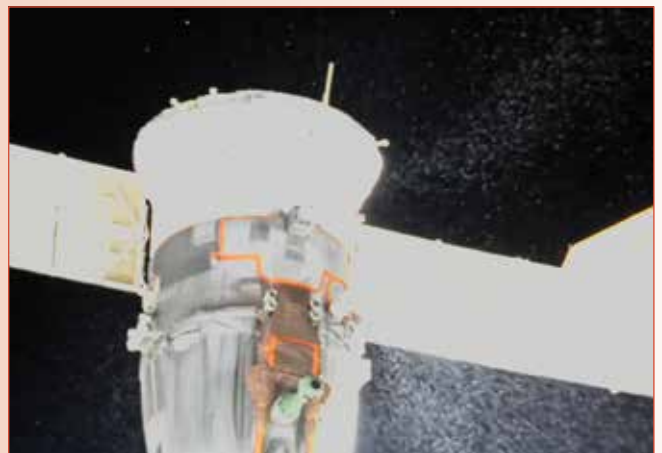
Links: de eerste satelliet van de derde generatie Meteosat satellieten, de MTG-I1, wordt op de adapter bovenop de Ariane-5 raket geplaatst. [ESA] Rechtsboven: op 5 december passeert Orion voor de tweede maal de Maan en begint aan de thuisreis. [NASA] Rechtsonder: Koelmiddel stroomt uit de lekke radiator van de Soyuz MS-22, mogelijk veroorzaakt door de inslag van een micro-meteoroid. [NASA TV]
