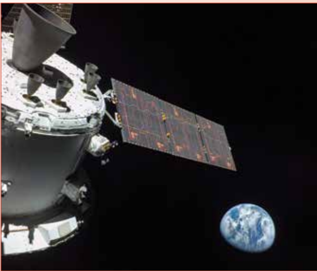
Linkerkolom. Boven: een camera boven in de lanceertoren legt het vertrek van de 98 meter hoge SLS raket vast aan het begin van de Artemis-1 missie. [NASA] Midden: een van de vier door Airbus D&S NL gebouwde zonnepanelen is zichtbaar als de Orion capsule 92.800 km van de Aarde is verwijderd. [NASA] Onder: taikonaut Chen Dong aan het werk buiten het Tiangong ruimtestation tijdens het uitstapje van 17 november. [CCTV]
