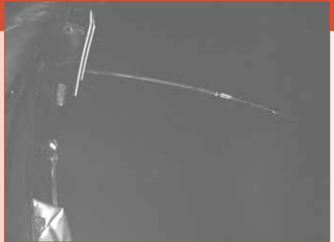
Op 12 mei slagen vluchtleaders er eindelijk in om de onwillige RIME-antenne van JUICE te ontplooiën. De 16-meter lange boom is onderdeel van een radarinstrument waarmee onder het ijsoppervlak van grote manen van Jupiter gekeken kan worden. [ESA]
