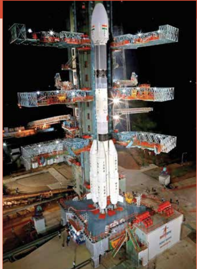
Technici bereiden de GSLV Mk. 2 raket voor op haar vlucht om een Indiase navigatiesatelliet in een geostationaire overgangsbaan te brengen. [ISRO]
