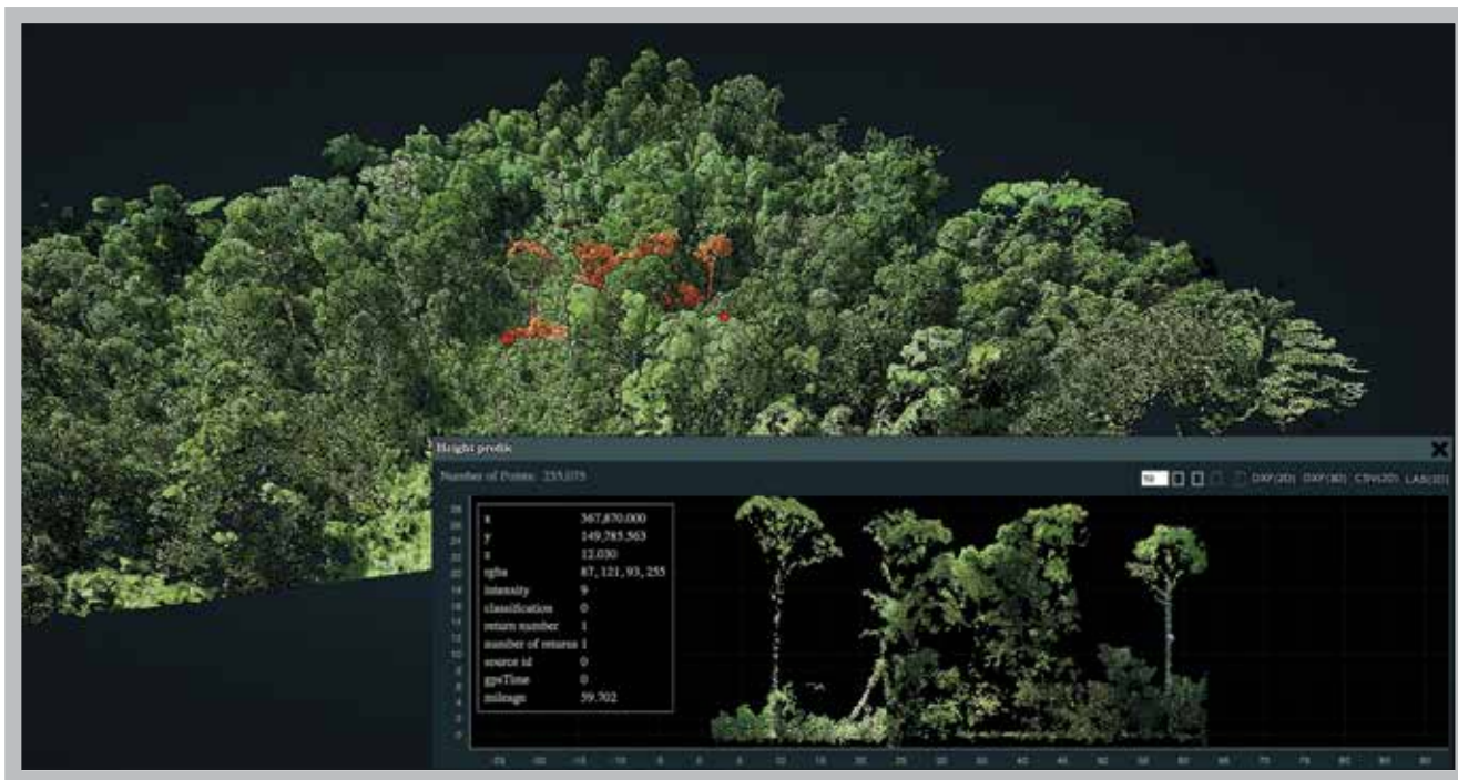
De resultaten van het verzamelen van drone-gegevens in een regenwoud in Zuidoost-Azië. De vluchtgegevens van de LiDAR (laser)drone zijn gecombineerd met de rode, groene en blauwe band van de multispectrale drone, net als bij een standaardcamera. Op de afbeelding zien we een dwarsdoorsnede van het regenwoud, met duidelijke verschillen per boomsoort. Hierdoor krijgen we een duidelijk overzicht van de huidige status van de biodiversiteit in het regenwoud.
