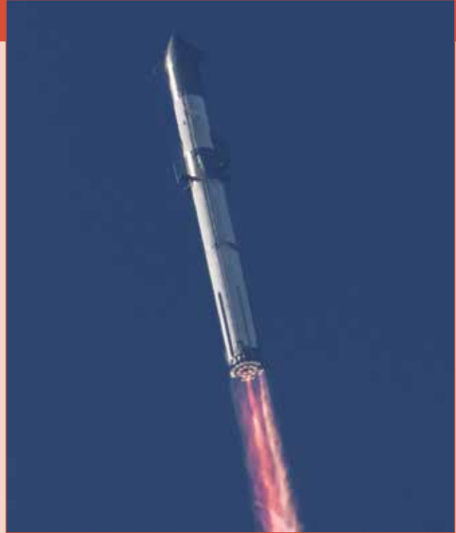
De eerste Super Heavy/Starship raket worstelt zich een weg naar de ruimte als ongeveer een minuut na de lancering al een aantal motoren zijn uitgevallen. [SpaceX]
