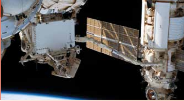
De in Nederland gebouwde robotarm ERA voert haar eerste grote operationele missie uit: ze verplaatst een pakket radiatoren van de Rassvet module naar het Nauka laboratorium. [NASA]
