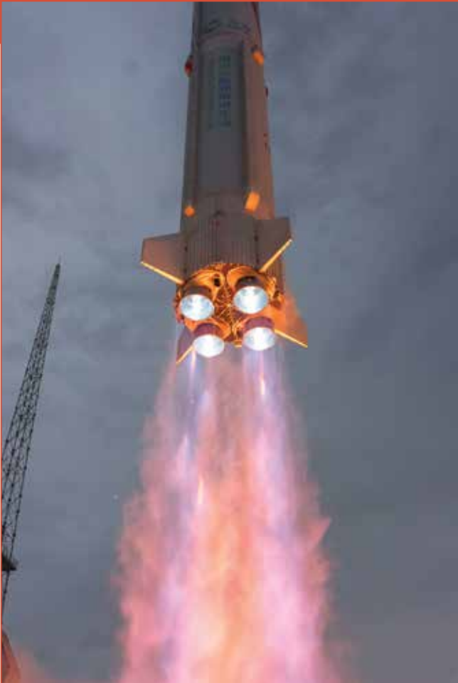
Het Chinese Landspace slaagt erin 's werelds eerste lancering met een draagraket op methaan en zuurstof uit te voeren. De Zhuque-2 brengt een massasimulator in een omloopbaan. [Landspace]
