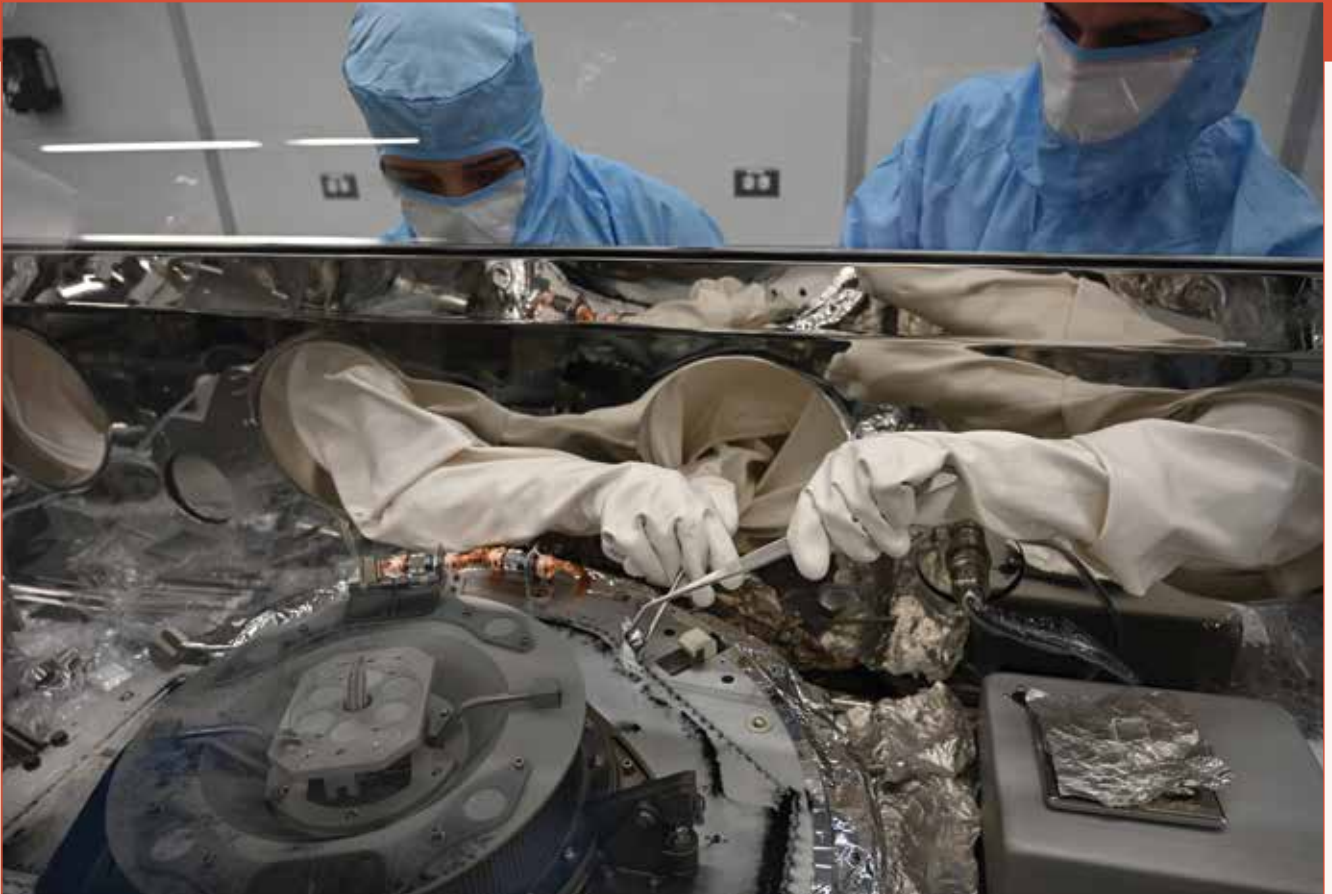
Wetenschappers openen de OSIRIS-REx container met bodemonsters van de planetoïde Bennu. [NASA]
