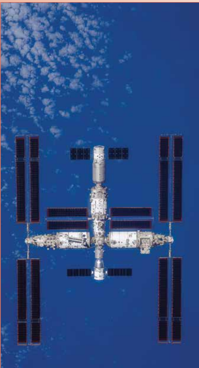
Kort na de ontkoppeling nam de Shenzhou-16 bemanning deze foto van het Chinese ruimtestation Tiangong. In het midden is de Tianhe woonmodule zichtbaar, met boven het vrachtschip Tianzhou-6 en onder de Shenzhou-17. Links de Wentian module met luchtsluis en de robotarm, rechts de laboratoriummodule Mengtian. [CMSE]
