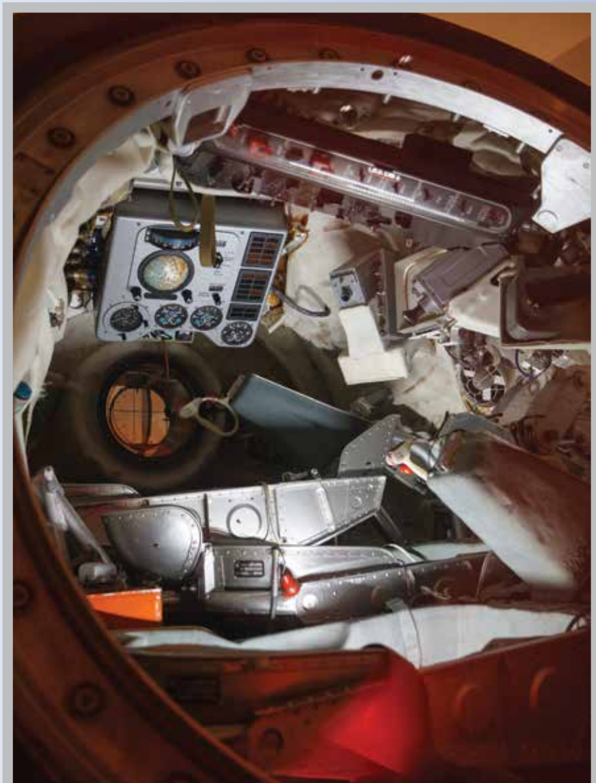
Het interieur van de Voschod, in feite een Wostok waarin de grote schietsstoel vervangen was door drie krappe zeteltjes. De bemanning moest naar links op de instrumenten kijken, want die waren op dezelfde plaats gebleven. Drukpakken konden vanwege de krappe ruimte niet worden gedragen. [Novosti Press]
