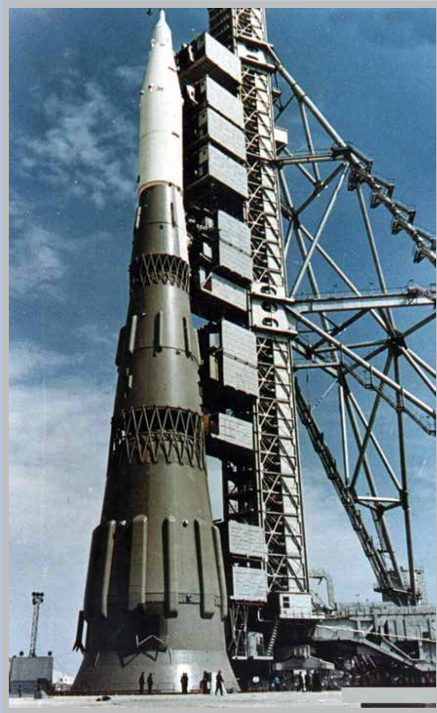
Proefopstelling van de Russische maanraket N-1, eind jaren zestig op de basis Baikonor in Kazachstan. [TASS]
